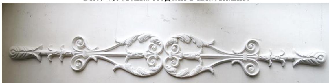
Рис. 41. Отливка модели в гипсе
