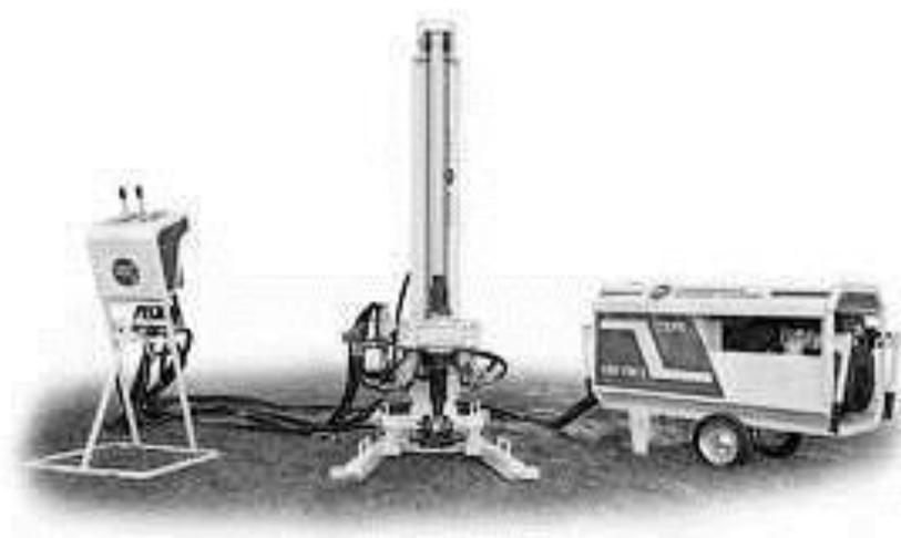
Рис. 9. Переносной буровой станок
