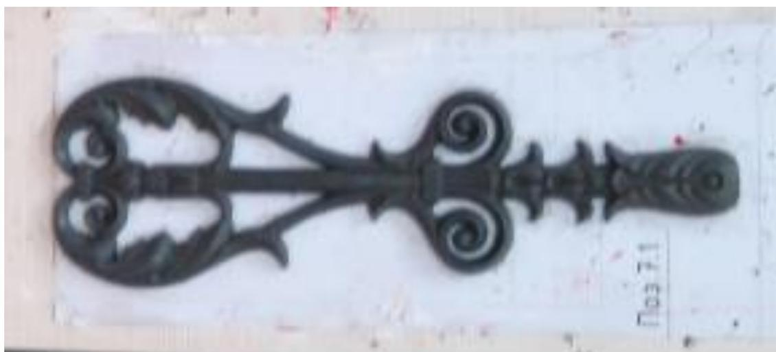
Рис. 40. Лепка модели в пластилине
